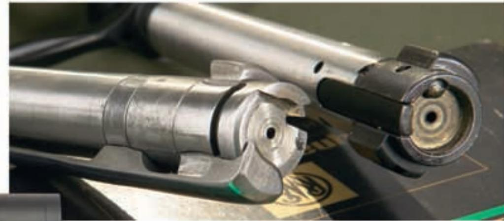
Mit zwei Warzen verriegeln beide Testwaffen in der Hülsenbrücke. Die CZ verfügt über den langen starren Auszieher à la Mauser 98. Außerdem sitzt bei ihr ein drittes Riegeelement hinten am Kammerstengel.
